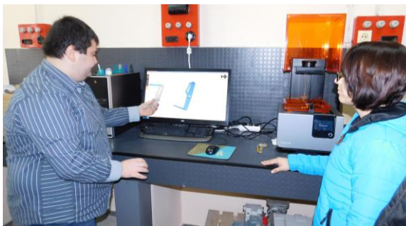
Фиг. 3. Подготовка за стереолитографичен (SLA) 3D печат на детайл от DTT-3
